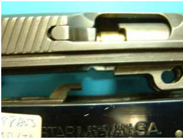
Superposición corredera y armazón, con vaina en recámara. Acción de la aguja y el tope
